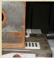
Rys.3.10. Sposób posadowienia szyny na łożysku liniowym
