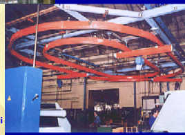
Przykłady jazdy torowych suwnic w wykonaniu specjalnym (torowisko owalne, torowisko z nierównoległymi gałkami)
