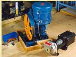
Porównanie gabarytów napędów dźwigu konwencjonalnego z napędem dźwigu Gen2
