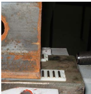
Rys/fot. 11 Sposób posadowienia szyny na łożysku liniowym
