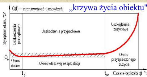
Intensywność uszkodzeń maszyny jako funkcja czasu eksploatacji
